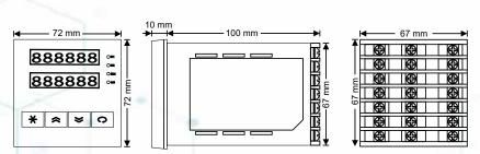
Panel Cutting Dimensions = 68 ± 0,5 mm x 68 ± 0,5 mm
